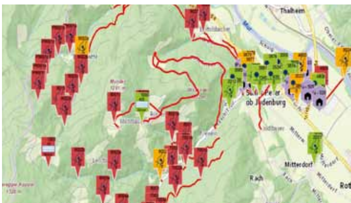
Wasserentnahmestellen und Zubringleitungen.
